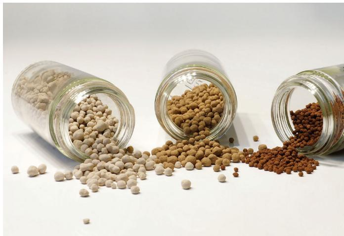
**Bild 5** Die sprühgranulierten Dünger sind abriebfest, staubfrei und weisen eine homogene Partikelstruktur und damit nicht zuletzt eine hohe Qualität auf.
